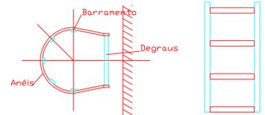
**DETALHE ESCADA DE MARINHEIRO COM GAIOLA DE PROTEÇÃO ESCALA 1/25**
