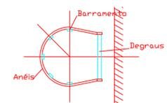
**DETALHE ESCADA DE MARINHEIRO COM GAIOLA DE PROTEÇÃO ESCALA 1/25**
