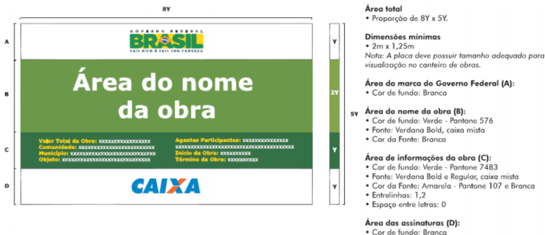
Figura 1 – Placa da obra. Fonte: Manual Visual de Placas e adesivos de obras.
